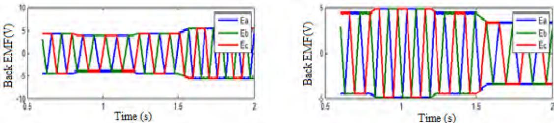
Figure. 5 (d) back EMF waveform of right and left side motor.
