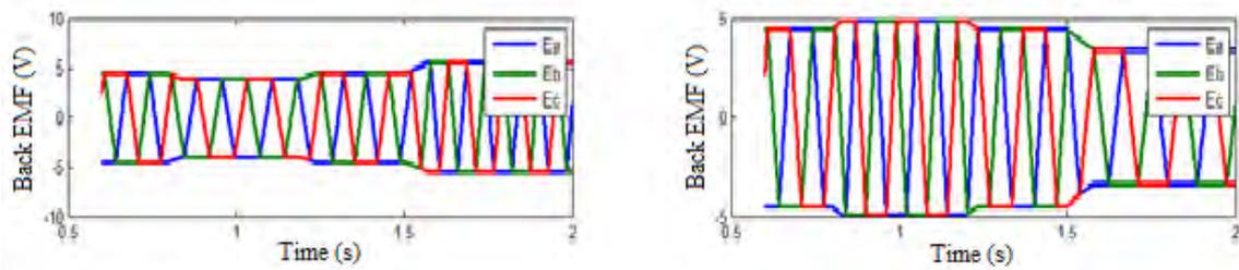
Figure.7 (d) back EMF of right and left side motor.
