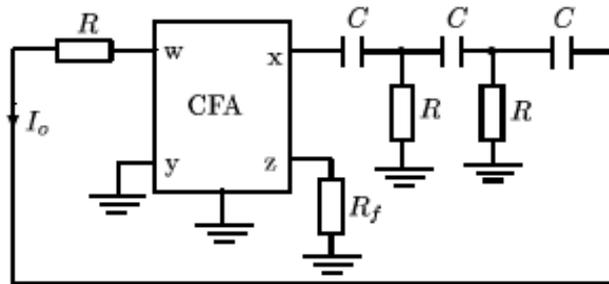
Fig. 16. CM phase shift oscillator.
