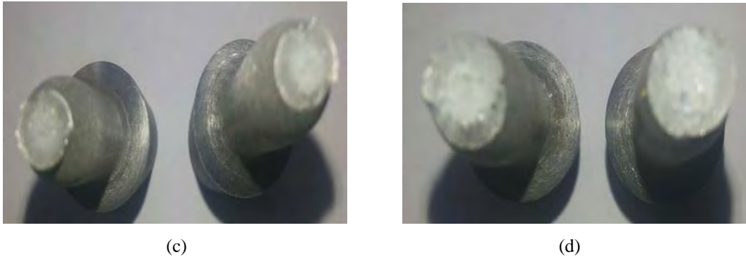
Fig.2. (a) SAE 1026 (b) SAE 4140 (c) SAE 5120 (d) SAE 8620 fracture specimen
