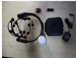
Fig 2: EEG Epoc Headset
