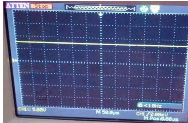
Fig.9. Rectifier output voltage
